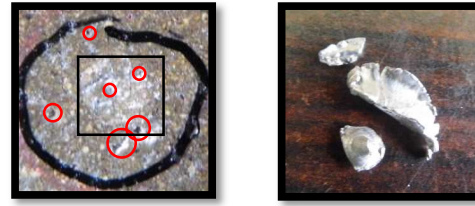
(a) (b) Gambar 13. a) Jejak proyektil pada spesimen, dan b) bentuk proyektil setelah mengenai spesimen pada jarak 3 m.
