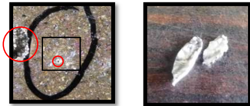
(a) (b) Gambar 11. a) Jejak proyektil pada spesimen, dan b) bentuk proyektil setelah mengenai spesimen pada jarak 2 m.
