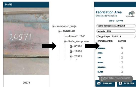
Gambar 17. Proses identifikasi komponen dan input laporan fabrikasi.
