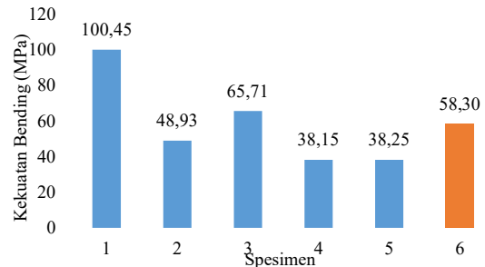
Gambar 5. Grafik hubungan campuran resin dan serat buah pinang terhadap kekuatan bending.
