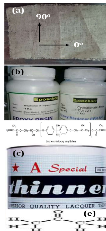
Gambar 1. (a) anyaman serat jute, (b) epoksi dan hardener dan (c) thinner.
